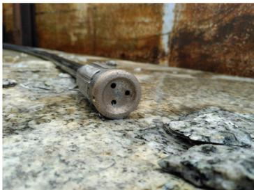
Ein kompaktes Bohrwerkzeug öffnet auch in Hunderten Metern Tiefe kostengünstig lange Bohrlöcher in hartem Gestein. Damit lassen sich geologische Ressourcen wie Erdwärme effizienter erschließen. Das »Micro Turbine Drilling (MTD)« genannte Verfahren hat Fraunhofer IEG nun erfolgreich im Untergrundlabor getestet.
