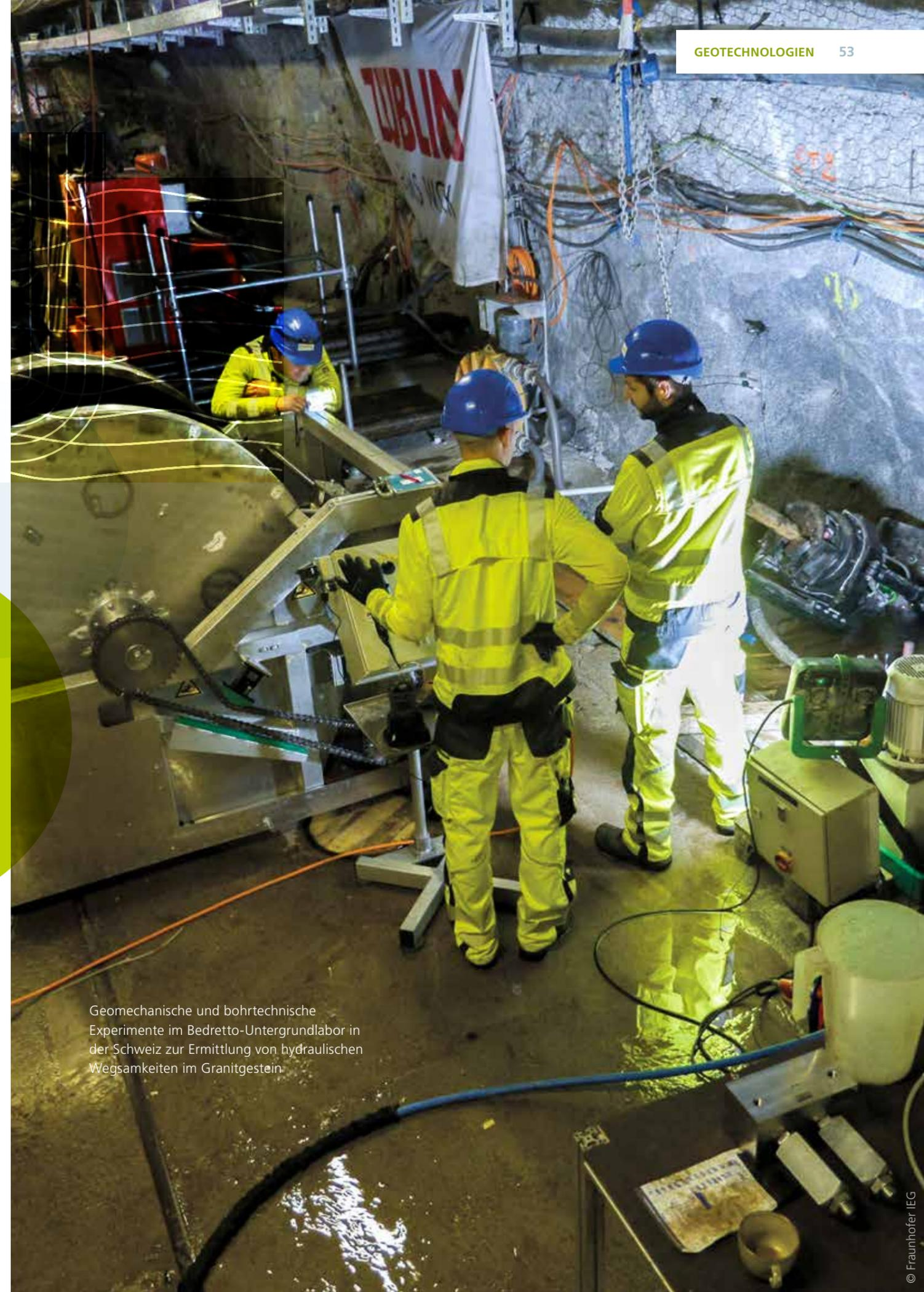
Geomechanische und bohrtechnische Experimente im Bedretto-Untergrundlabor in der Schweiz zur Ermittlung von hydraulischen Wegsamkeiten im Granitgestein
