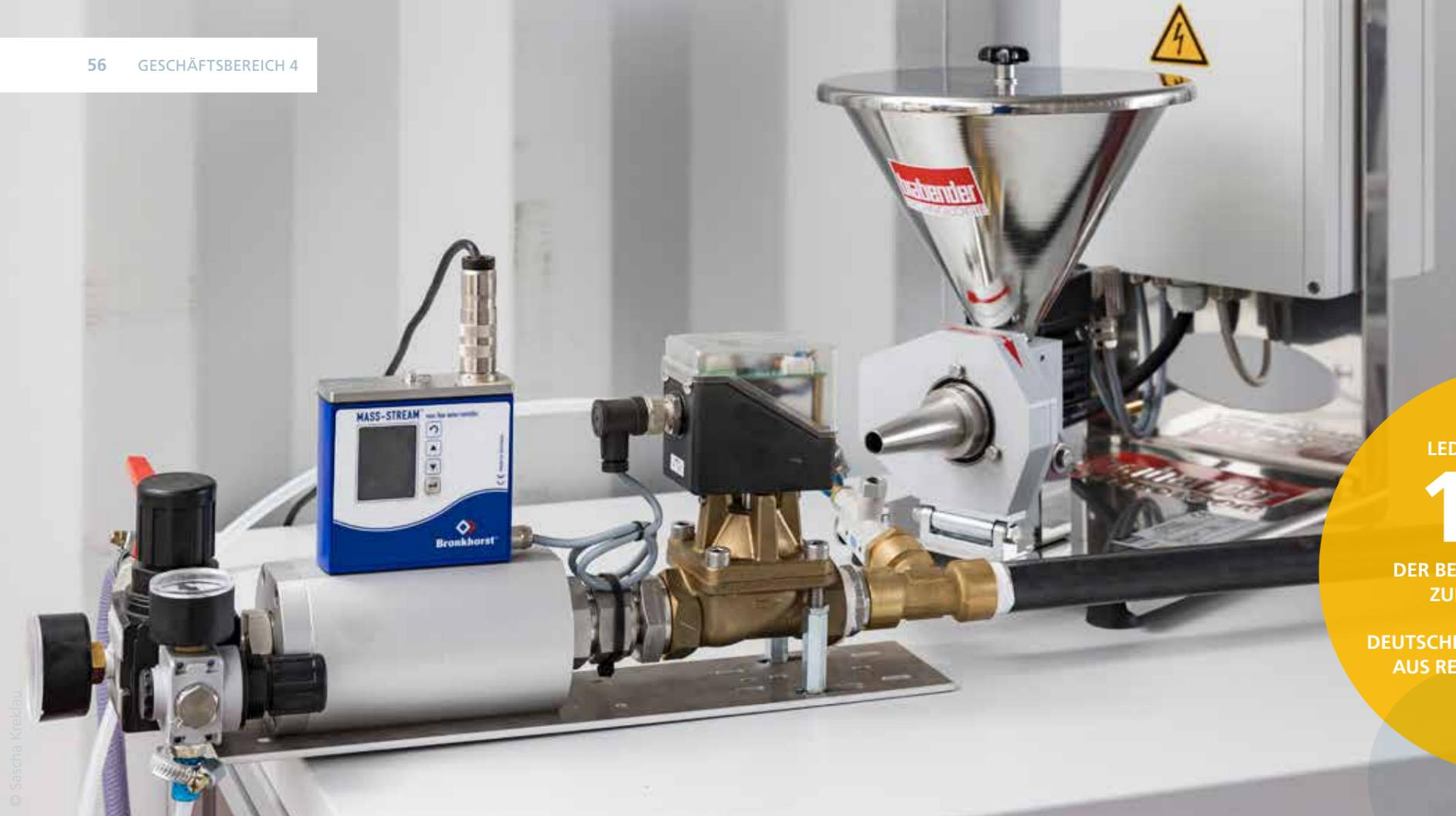
Laborreaktor zur Synthese künstlicher geothermaler Fluide
