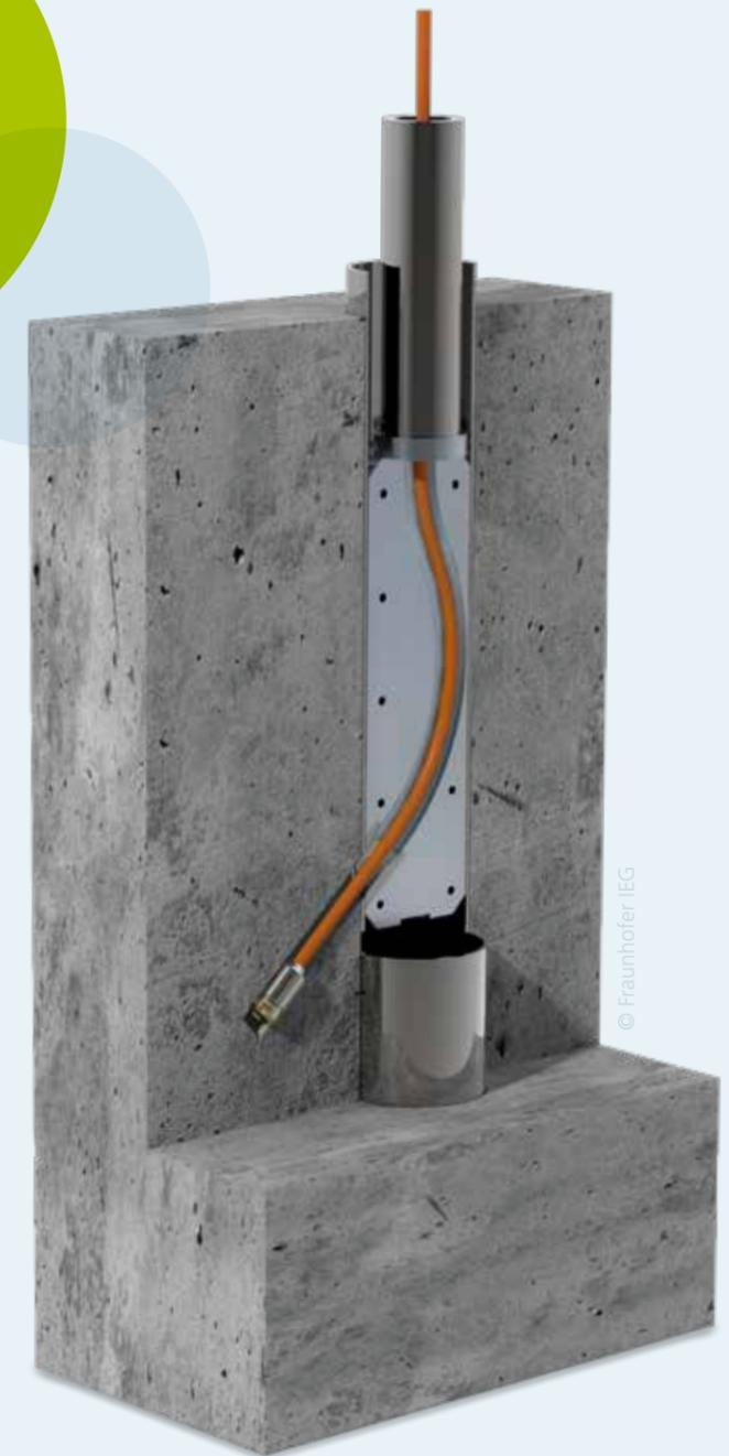
Über einen Ablenkschuh wird die Mikroturbine im Bohrloch abgelenkt und in das Umgebungsgestein getrieben
