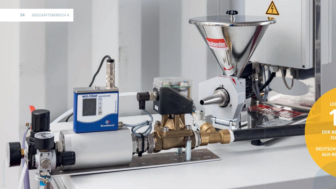
Laborreaktor zur Synthese künstlicher geothermaler Fluide
