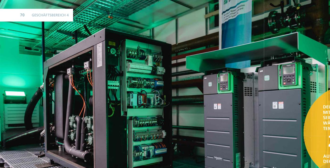
Die Forschungs- und Erprobungsanlage für Großwärmepumpen erlaubt die Vermessung von Maschinen der Megawattklasse.
