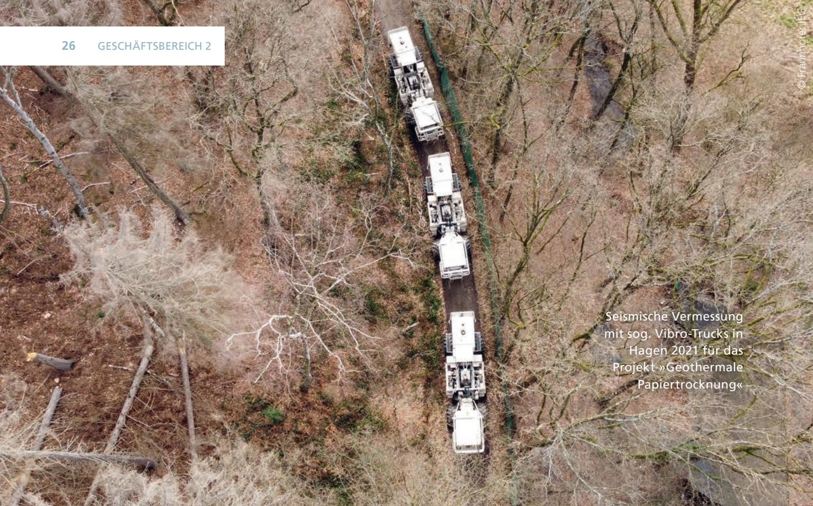
Seismische Vermessung mit sog. Vibro-Trucks in Hagen 2021 für das Projekt »Geothermale Papiertrocknung«
