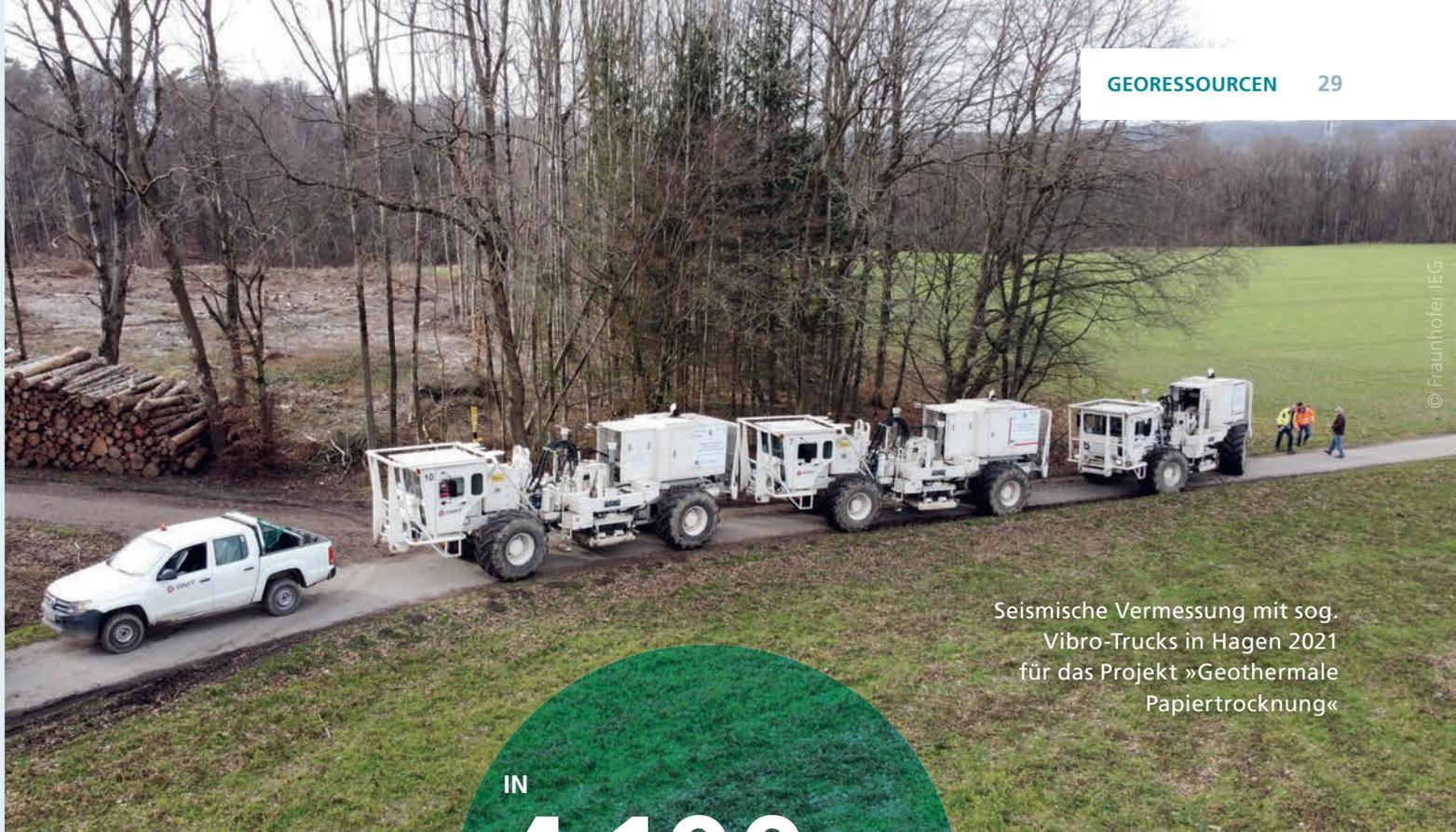
Seismische Vermessung mit sog. Vibro-Trucks in Hagen 2021 für das Projekt »Geothermale Papiertrocknung«
