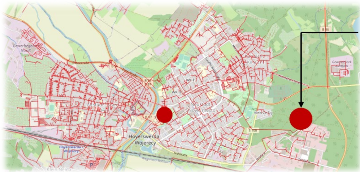
Abbildung 20 Ausbauzustand des Wärmenetzes in Hoyerswerda mit seinen Einspeisepunkten im Wärmenetz (rot markiert)
